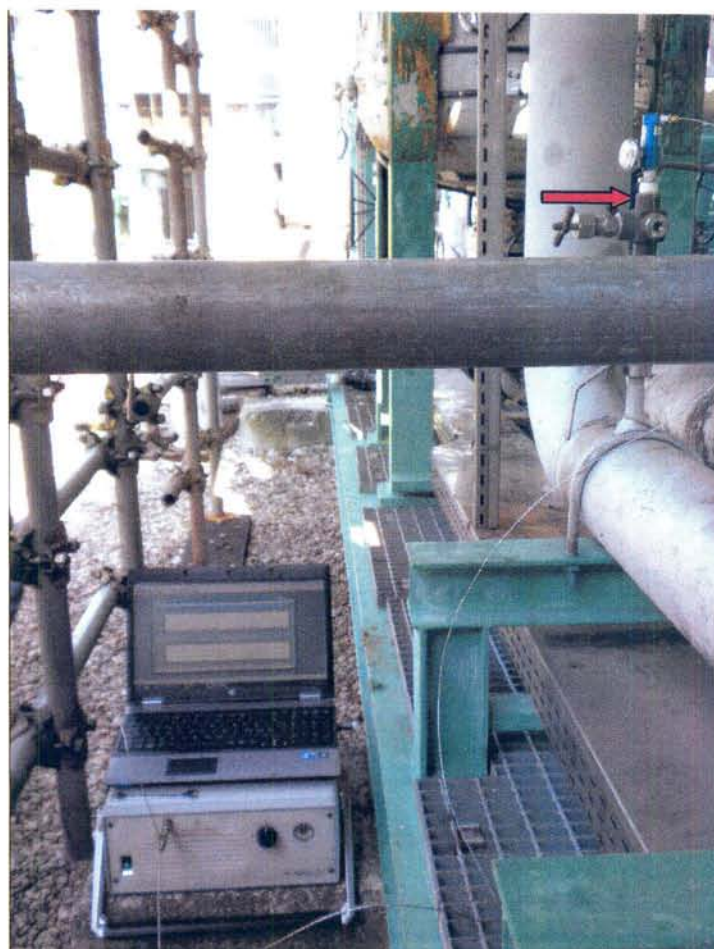
Foto 1 – Punto di campionamento (freccia di colore rosso) e gascromatografo portatile \mu GC 3000 Agilent
